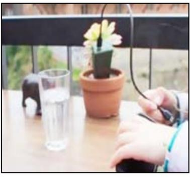
جزء من هذا الشاحن في تربة وعاء نبذة ما، ليقوم بتوليد طاقة كهربائية تعادل كميتها ه فولتات أي نحو 600 مللي أمبير. وصرح الفريق القائم على هذا المشروع بأن هذه الكمية من الطاقة كافية لشحن هاتف وجعله يعمل لمدة ساعة ونصف ساعة من الاستخدام. وأشار المخترعون إلى أن هذه الطريقة التي يتم بواسطتها توليد الطاقة لا تسبب أي ضرر للنباتات. ويطمح المشروع إلى توفير
